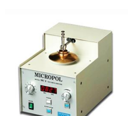
MC3型 マイクロポール TEM サンプル精密研磨装置
